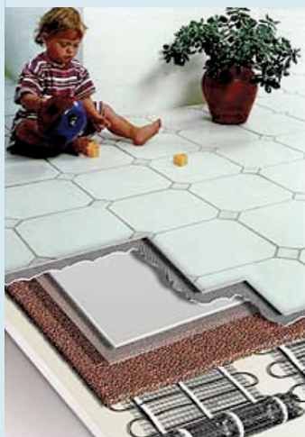
Figura 4 Incorporação de materiais de mudança de fase num piso com aquecimento
