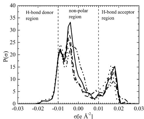
**Figure 3.**  $\sigma$ -profiles of [Ch][HEPES] (-----), [Ch][MES] (-.-.-), [Ch][TES] (.....), [Ch][Tricine] (-.-.-), and [Ch][CHES] (—).
