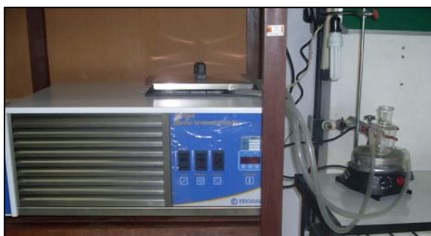
Figura 5 - Aparato experimental utilizado para a determinação das curvas de equilíbrio líquido-líquido.
