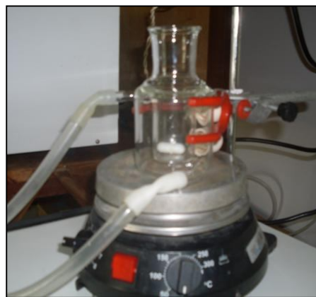
Figura 5 - Aparato experimental utilizado para a determinação das curvas de equilíbrio líquido-líquido.
