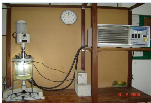
Figura 4 - Aparato experimental utilizado para a realização da reacção de transesterificação.
